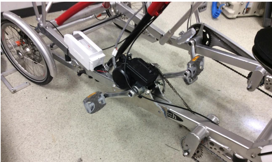
図 4 : アシストユニットがついた 4 輪自転車
