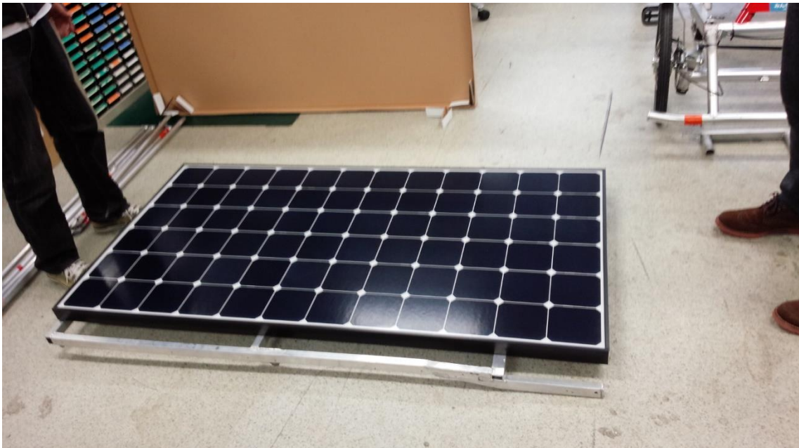
図 2 : ソーラーパネルがついた屋根フレーム
